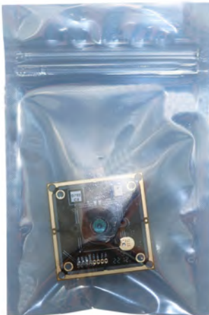
Sigillare il vassoio con un sacchetto antistatico
